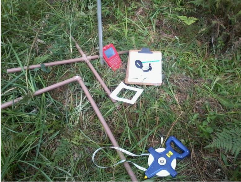
FIGURA 3 - Material utilizado para realização das medidas ambientais, destacando a cruz de PVC para localização dos quadrantes onde foi medida a vegetação, o quadrado de PVC para as medidas da serrapilheira, o quadrado de 10 cm para avaliação do dossel (mais detalhes no texto).
